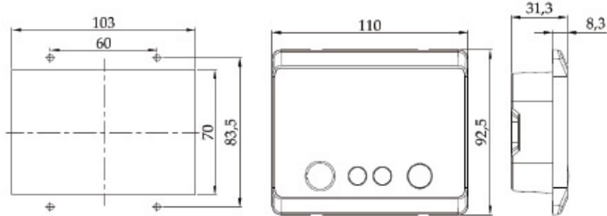
Abbildung 2.1: Abmessungen MEH-B
